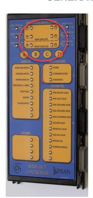
PIN STATE SHOWN ON LOGIC MODULE
